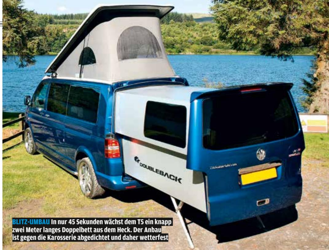
**BLITZ-UMBAU** In nur 45 Sekunden wächst dem T5 ein knapp zwei Meter langes Doppelbett aus dem Heck. Der Anbau ist gegen die Karosserie abgedichtet und daher wetterfest
