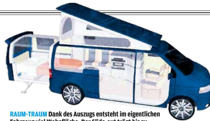
**RAUM-TRAUM** Dank des Auszugs entsteht im eigentlichen Fahrzeug viel Wohnfläche. Der Slide-out trägt bis zu 400 Kilo und kann mit der Hecktür verschlossen werden
